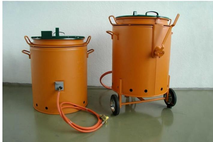
Pour chauffer des masses de scellement bitumineuses pour joints
